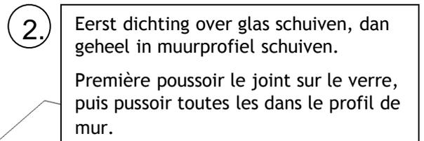
Eerst dichting over glas schuiven, dan geheel in muurprofiel schuiven.
